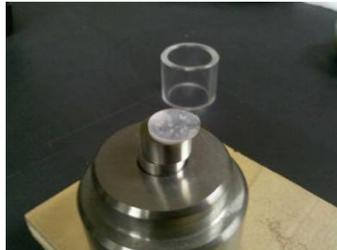
Separar a massa de KBr necessária e colocar na secagem (entre 100mg e 300mg cada)
